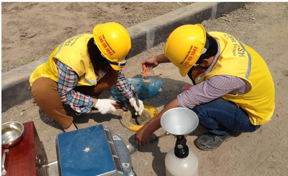
Thí nghiệm kiểm tra đầm chặt san nền
