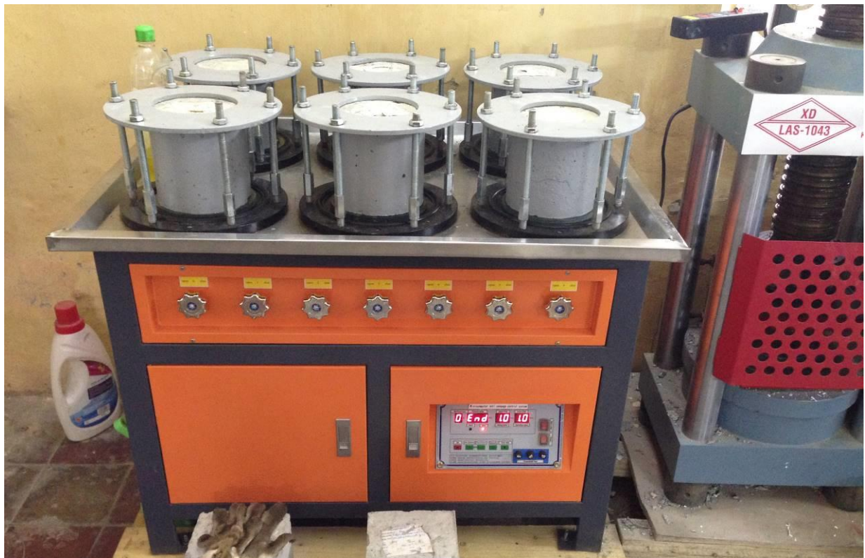
Thí nghiệm kiểm tra độ thấm nước của bê tông
