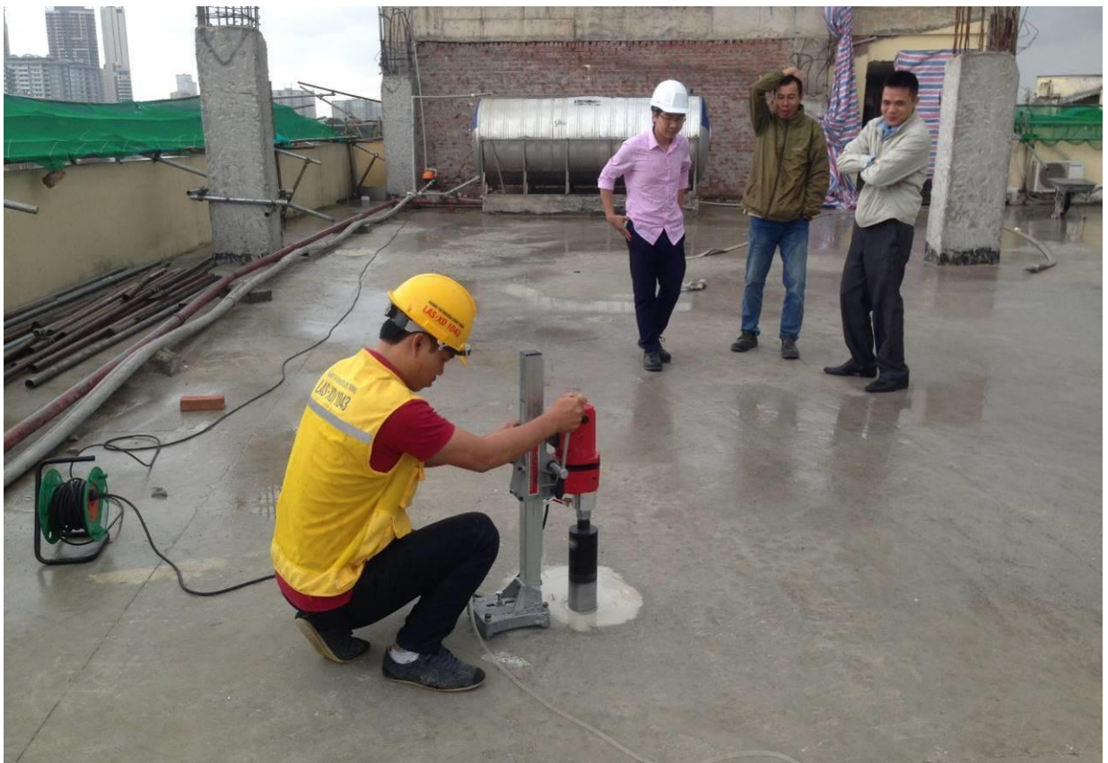
Kiểm định chất lượng bê tông đầm sàn bằng phương pháp khoan lấy mẫu
