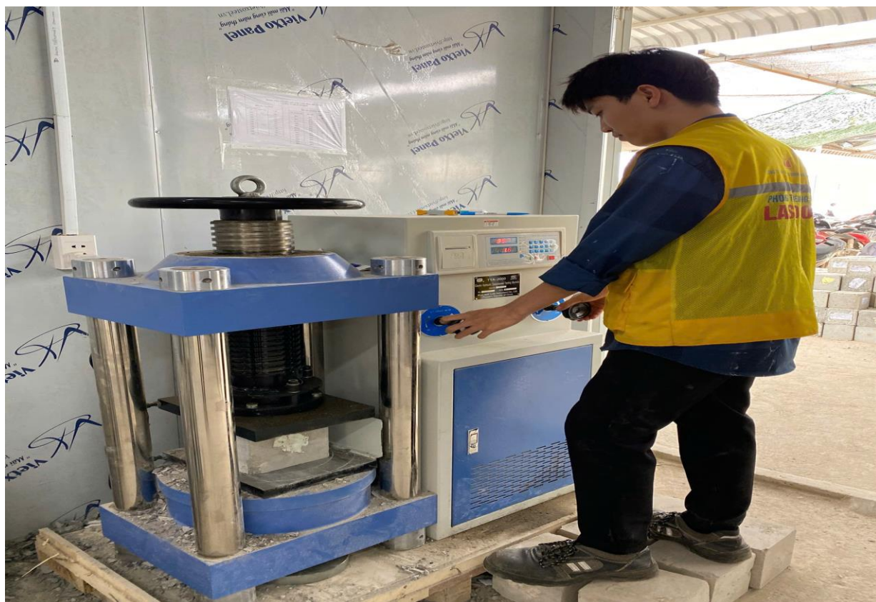
Kiểm tra cường độ của bê tông
