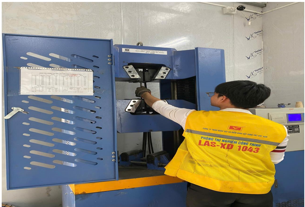
Thí nghiệm kiểm tra chỉ tiêu cơ lý của thép xây dựng
